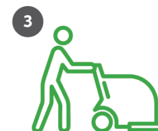
3 Puhdista lattia. Tarkista että ajolinjat ovat mahdollisimman pitkiä ja yhdensuuntaisia sekä osittain päällekkäisiä.
