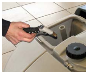
11. Puhdista likavesisäiliö puhtaalla vedellä.
