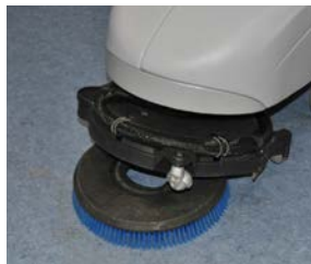
4. Aseta harja tai vetoalusta harjajyksikköön. Käytä oikeanlaista vaihtoehtoa lattian puhdistamiseen.
