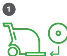
1 Kiinnitä laikka vetoalustaan värillinen, tekstitön puoli kohti lattiaa.
